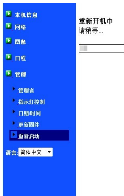
图 3-28: 系统重新启动持续页面
