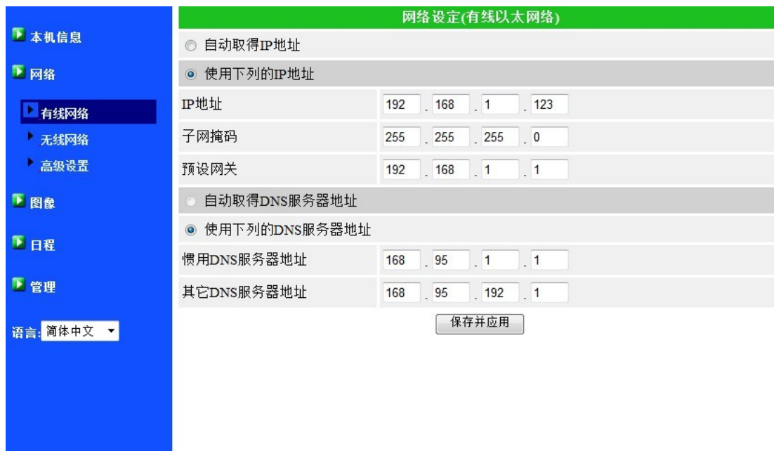
图 3-6: “Web 设置” 页上的固定 IP 地址设置
